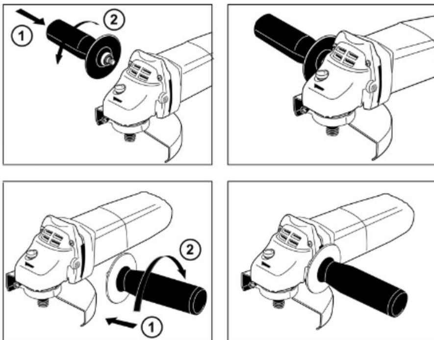
Для удобства выполнения работ дополнительную рукоятку 5 можно установить с левой и с правой стороны редуктора. Вставьте рукоятку в соответствующее резьбовое отверстие и заверните до упора по часовой стрелке.
